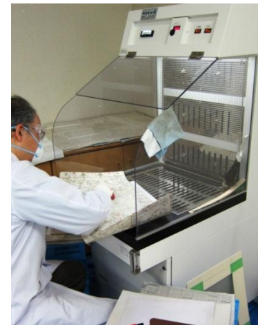
集塵機ダスペットⅡの使用
