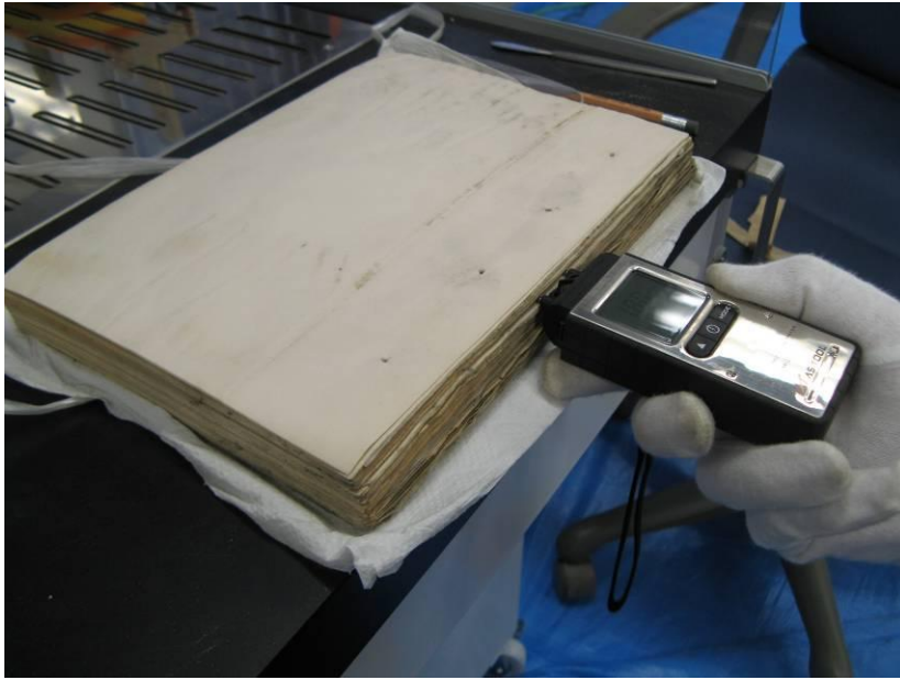
写真1 水分計による水分率の計測
