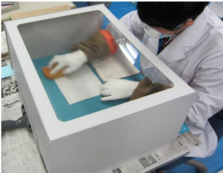
東京文書救援隊が開発した「ドライクリーニングBOX」を使用してのドライクリーニング作業
