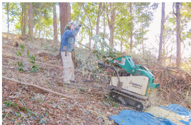
伐採した竹をチップパーで粉砕しています。
